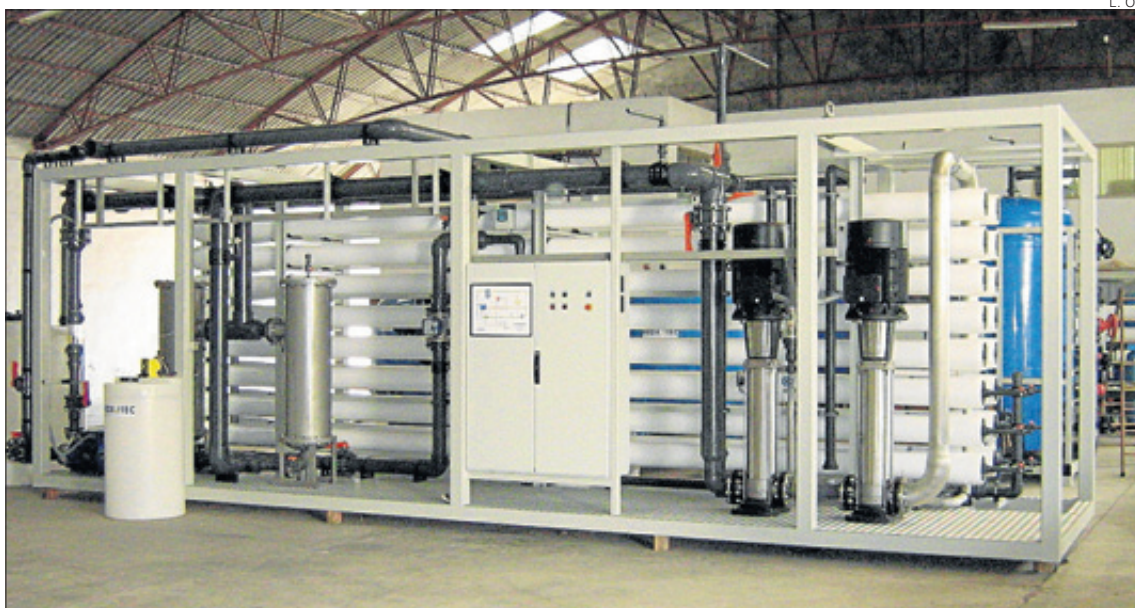
Una planta tipo ECO que produce hasta 2.500 metros cúbicos al día de agua desalada
